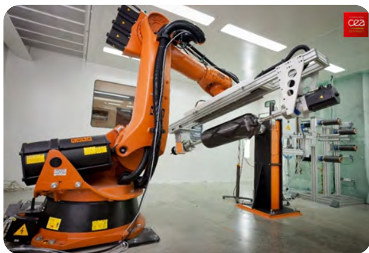
Machine robotisée d'enroulement filamenteux pour la fabrication de composites autour d'un liner polymère © CEA
