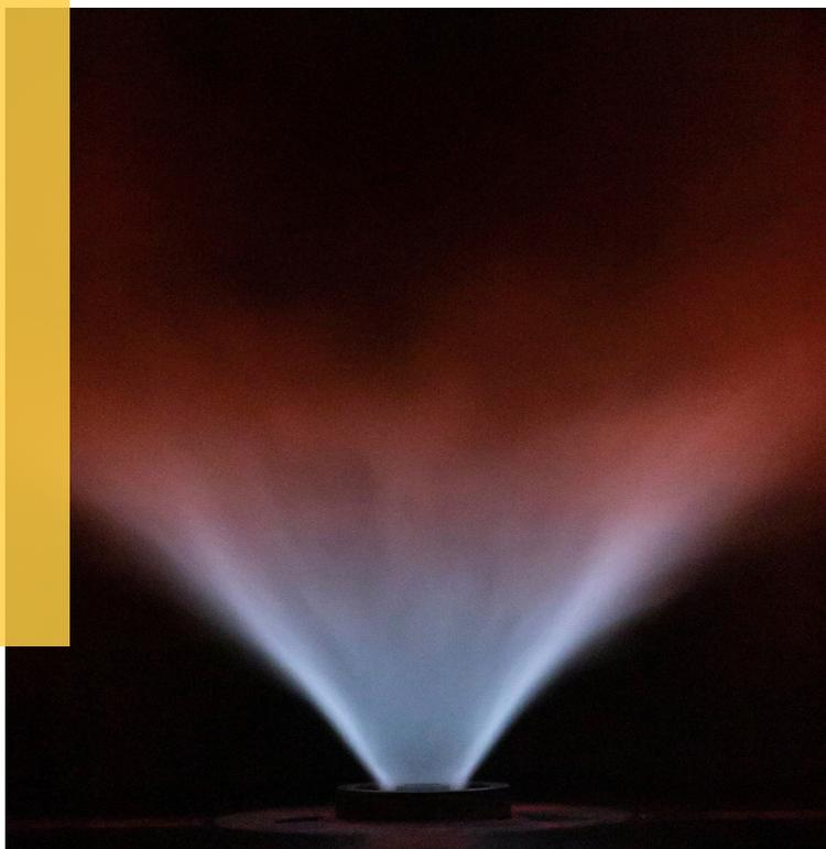
Photographie d'une flamme hydrogène-air stabilisée au-dessus d'un injecteur coaxial à double vrille du laboratoire EM2C-CNRS.
